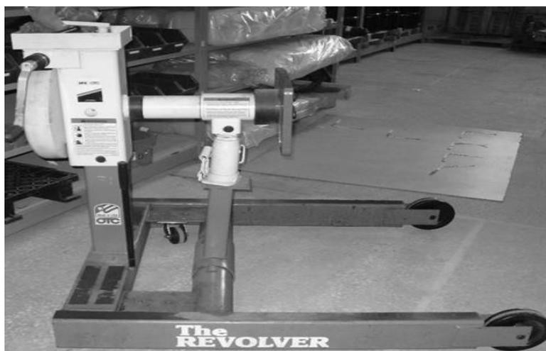
Рисунок 1. - Стелд для разборки сборки двигателей
