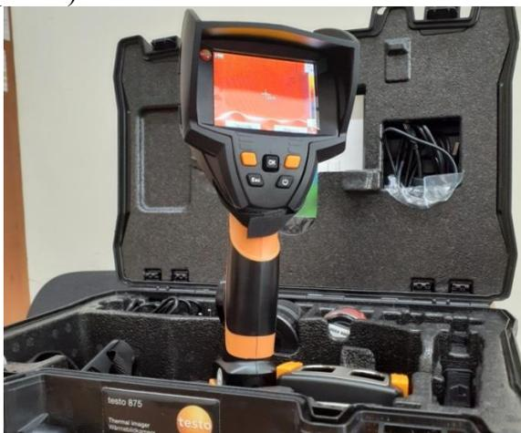
Рисунок 1 – Портативный тепловизор testo 875i
